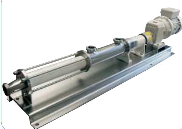
Основное применение насосов серии X - в пищевой промышленности. Специальная конструкция без мертвых зон в рабочей части позволяет уберечь перекачиваемый продукт от порчи бактериями и попадания смазочных веществ, а также легко промывать насос после работы. Насос может оснащаться дополнительными присоединениями для CIP мойки и подпирающим шнеком для перекачки вязких продуктов.
