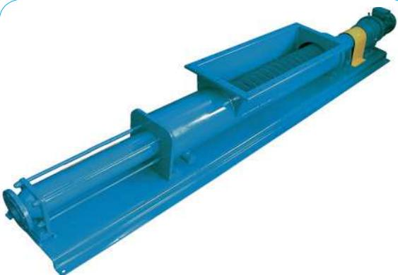
Вспомогательный шnek особой S-образной формы в приемном бункере насосов серии HS делает насос способным перекачивать вязкие жидкости и жидкости с большим содержанием сухого вещества (до 40%). Основное применение насосов серии HS - работа в индустрии очистки и переработки сточных вод, подача стоков на конвейер, работа по перекачке после фильтр-пресса.
