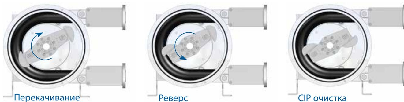
PT-насосам доступна опция "CIP-колесо" (Очистка без разборки), что позволяет пользователям просто изменить направление вращения насоса (поворот), чтобы можно было автоматически развернуть башмаки, чтобы реализовать процедуры очистки и стерилизации, не предпринимая каких-либо специальных действий с насосом. Клиент экономит время и сохраняет высокий уровень функционирования процесса.
