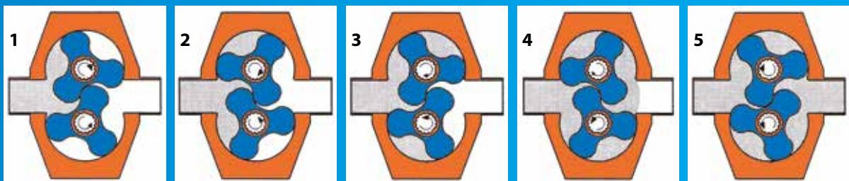
При выходе кулачков роторов из зацепления, объём камеры, заключенной между ними, увеличивается, что приводит к снижению давления (разрежению) во всасывающем патрубке насоса и обеспечивает приток жидкости из всасывающего трубопровода (рис. 1).
