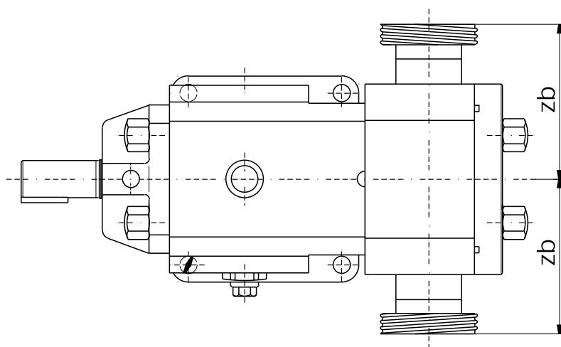
1 - все резьбовые (DIN, SMS, DS, BS, ISO, резьба для газовых труб, резьба NPT) и клеммовые соединения (ISO, SMS, DIN)
