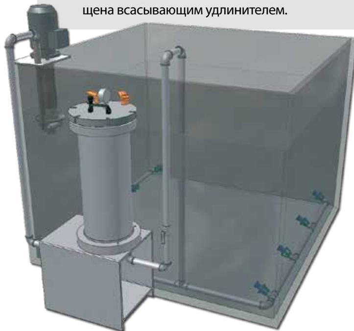
Насос CTV обычно устанавливается в ваннах для обработки поверхности, циркулируя через фильтр и далее к форсункам.
